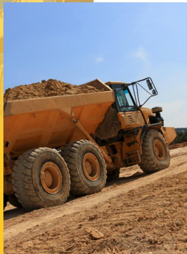
De nombreux engins évoluent hors-route ou travaillent à poste fixe. Le pneu doit alors répondre aux besoins de stabilité sous charge et de résistance aux agressions (ripage, coupure) dues aux manœuvres sur terrain non stabilisé. Selon leur usage, les pneus destinés aux engins de chantier présentent des gommes et des épaisseurs de bande de roulement distinctes ; les experts BestDrive sauront vous conseiller les produits les mieux adaptés à vos besoins.
